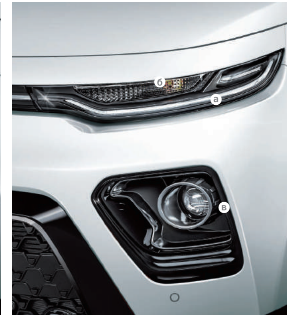
Передняя оптика Luxe: а) Светодиодные дневные ходовые огни, б) Светодиодные фары головного света, в) Проекционная фара головного света
