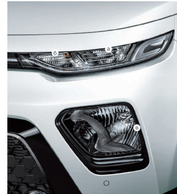
Передняя оптика Classic, Comfort: а) Дневные ходовые огни, б) Указатель поворота, в) Фара головного света
